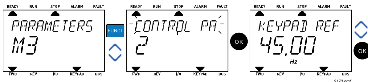
Figure 13. Accès à la page de contrôle
