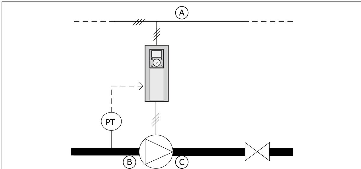
Imag. 78: La ubicación del sensor de presión
