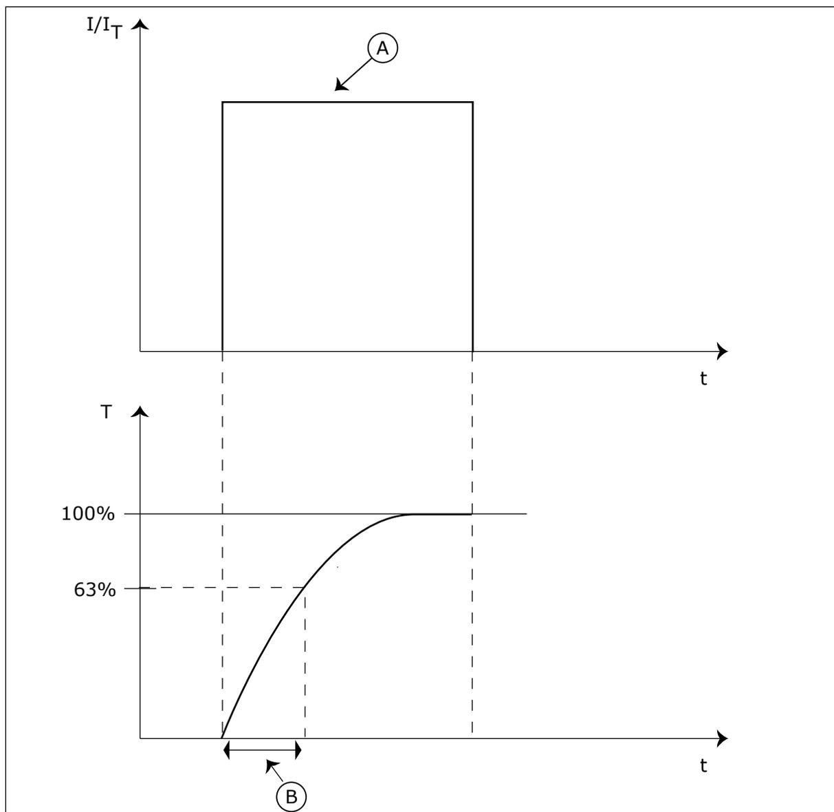
Imag. 57: La constante de tiempo térmico del motor
