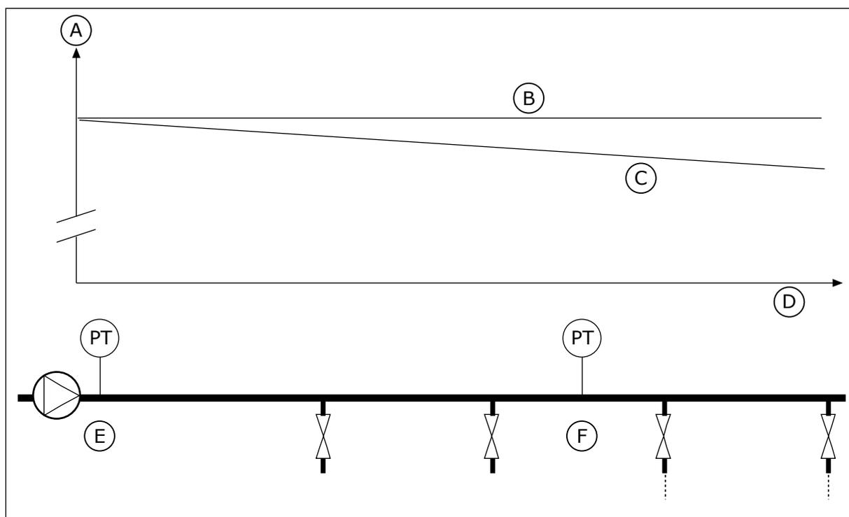
Imag. 75: La posición del sensor de presión
