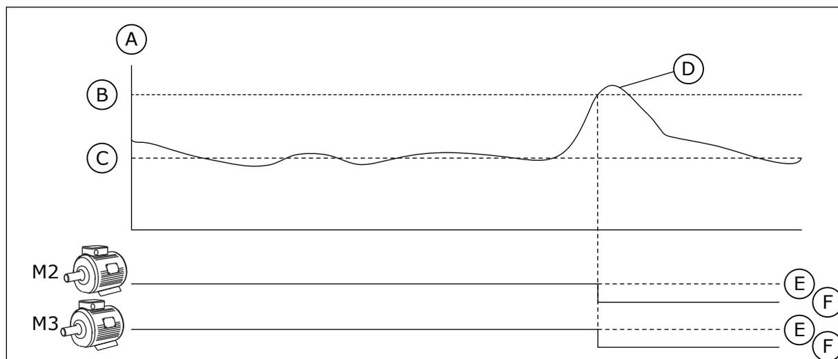
Imag. 86: La función de supervisión de sobrepresión
