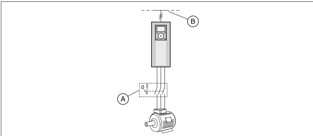
Imag. 20: El contactor del motor entre el convertidor y el motor
