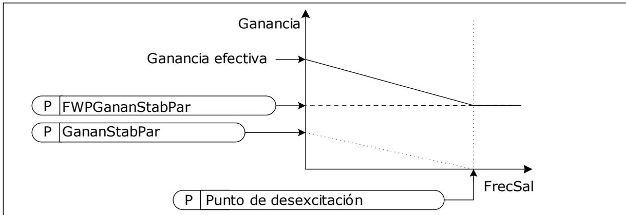
Imag. 26: La ganancia del estabilizador de par
