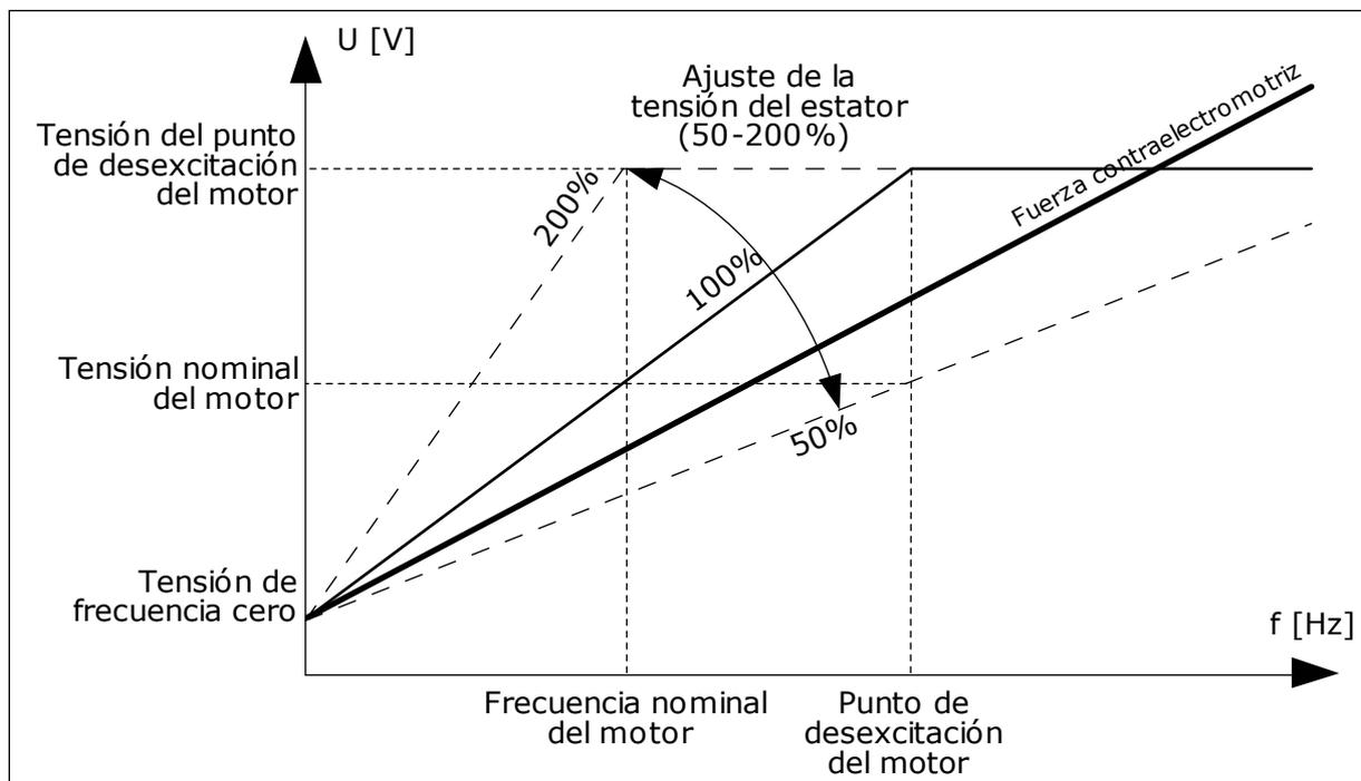
Imag. 22: El ajuste de tensión del estátor
