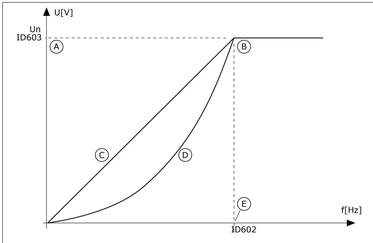
Imag. 23: Cambio lineal y cuadrático de la tensión del motor
