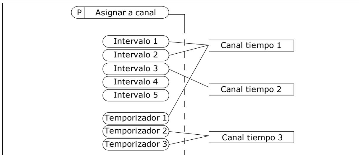
Imag. 64: La asignación de intervalos y temporizadores a los canales de tiempo es flexible. Cada intervalo y cada temporizador tiene un parámetro con el cual puede asignarlos a un canal de tiempo.
