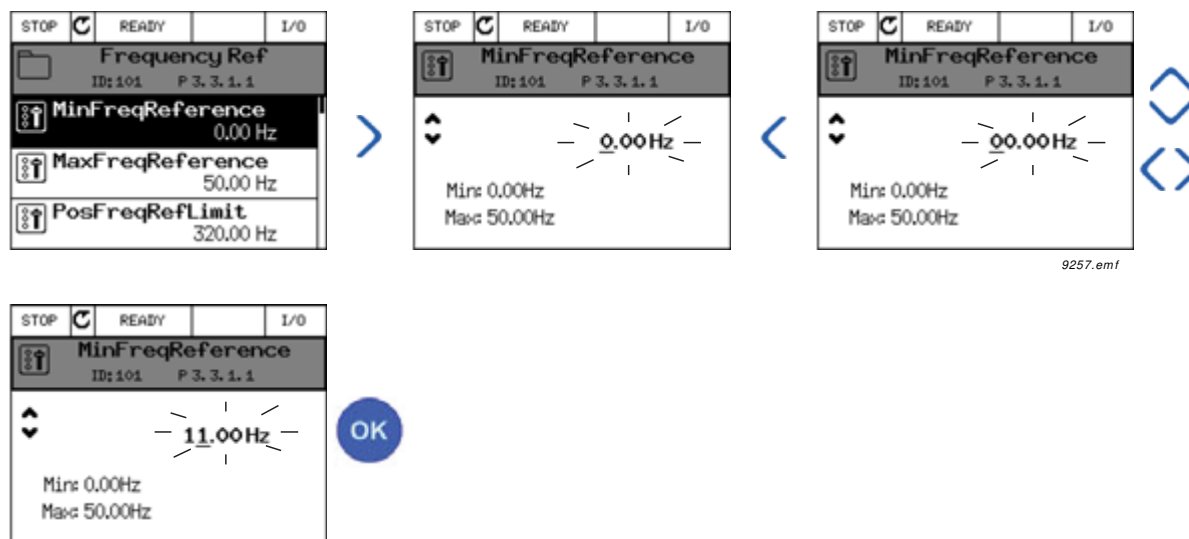
Figura 5. Editarea tipică a valorilor pe panoul de comandă grafic (valoare numerică)
