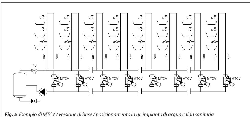
**Fig. 5** Esempio di MTCV / versione di base / posizionamento in un impianto di acqua calda sanitaria
