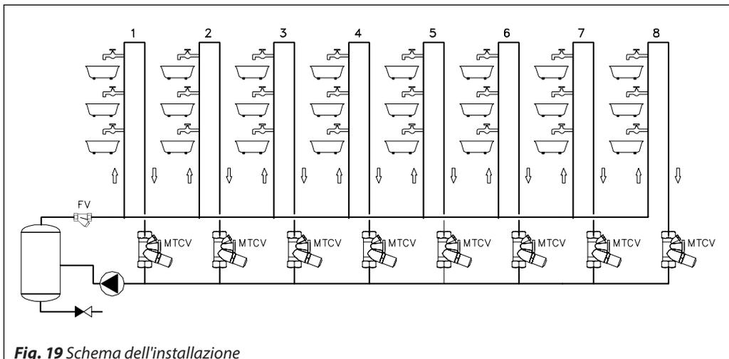
Fig. 19 Schema dell'installazione
