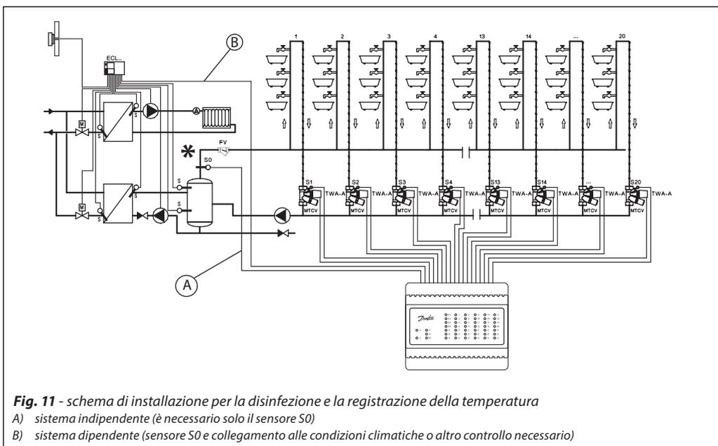
**Fig. 11** - schema di installazione per la disinfezione e la registrazione della temperatura
