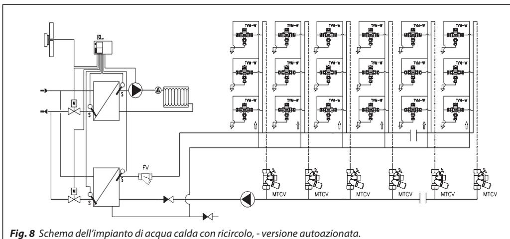
Fig. 8 Schema dell'impianto di acqua calda con ricircolo, - versione autoazionata.
