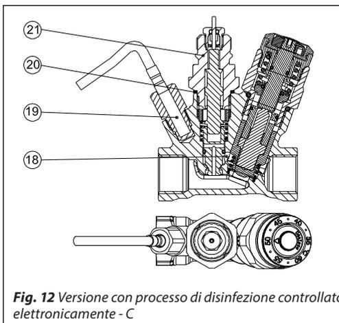
**Fig. 12** Versione con processo di disinfezione controllato elettronicamente - C
