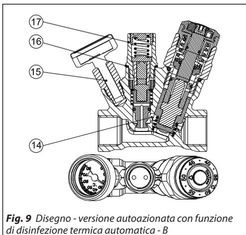
Fig. 9 Disegno - versione autoazionata con funzione di disinfezione termica automatica - B
