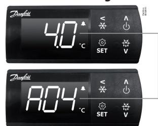
I codici di temperatura e di allarme lampeggiano alternativamente fino a quando il problema correlato all'allarme non viene risolto. La campanella di allarme lampeggia durante una condizione di allarme.
