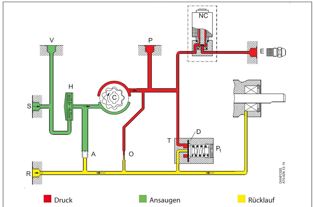
Vom Ansaugstutzen (S) wird Öl durch den Filter (H) zum Zahnradsatz, in dem der Druck erhöht wird, angesaugt. Wenn Spannung an das NC-Ventil angelegt wird (stromlos geschlossen), öffnet sich dieses und gibt das Öl zum Düsenanschluss frei.
