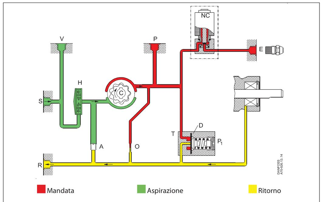
Dal foro di aspirazione (S), l'olio è portato attraverso il filtro (H) all'ingranaggio dove la pressione incrementa il suo valore. Una volta che la tensione viene applicata alla valvola NC (normalmente chiusa), questa si apre e l'olio fluisce verso l'ugello.
