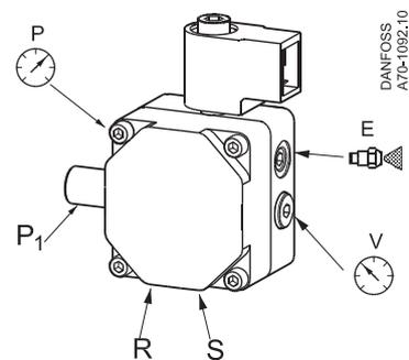
*Hinweis! Drehrichtung, Düsenanschluss und weitere Anschlüsse werden auf das Wellenende gesehen angegeben.*
